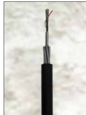
Рис. 2. Кабель волоконно-оптический с одномодовым или многомодовым волокном, броней из стальной оцинкованной проволоки со стальной центральной модульной трубкой
